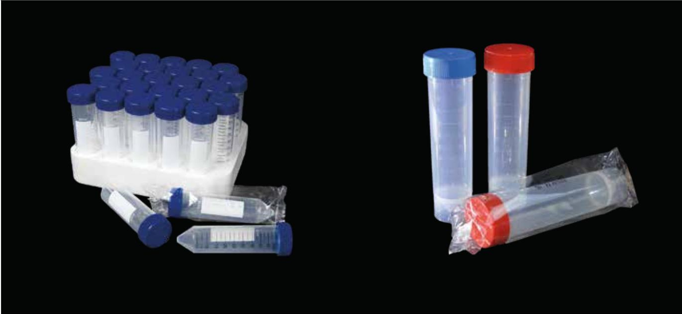
Reagenzgläser aus Polypropylen im Siebdruckverfahren bedruckt und mit festem Schraubverschluss. Maße: 30 x 115 mm. RCF max= 10.000 g. Autoklavierbar bei +121 °C und gefrierbar bis -80 °C.
