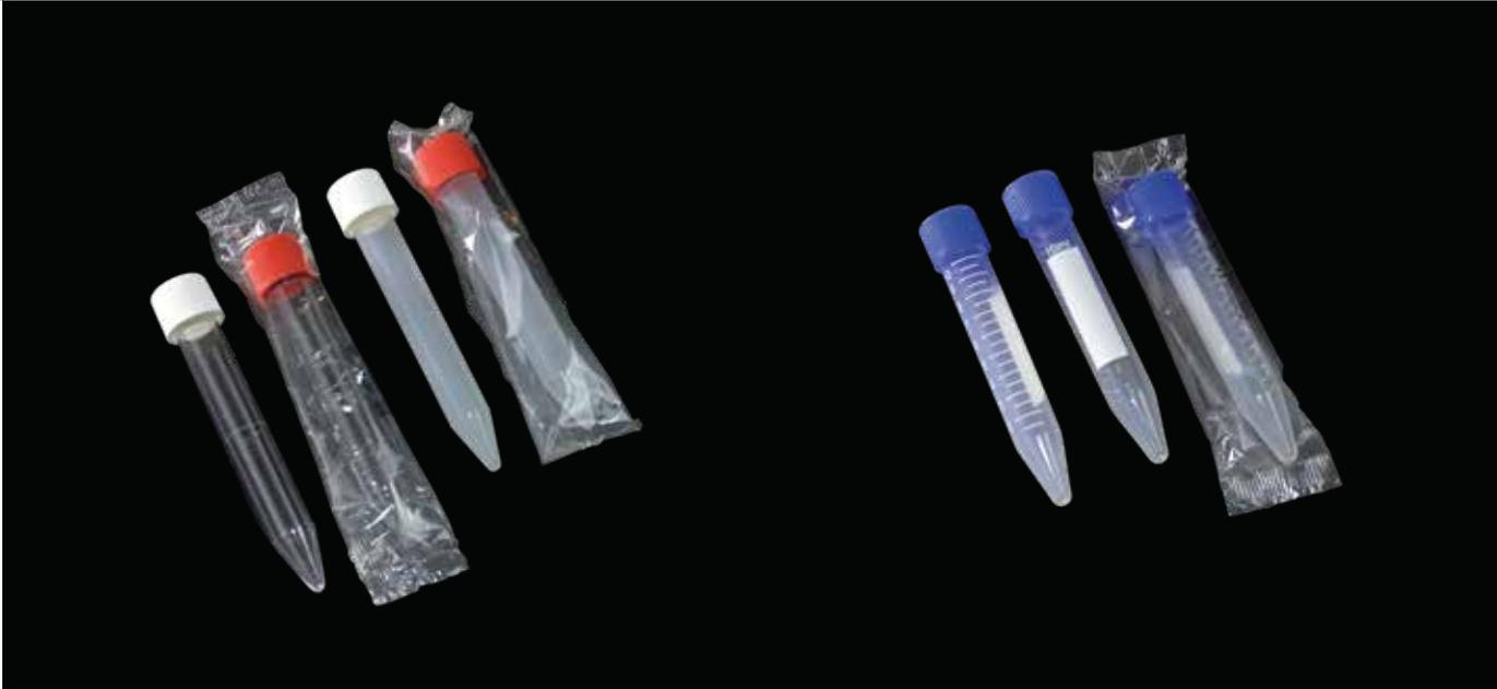
Erhältlich in Polystyrol und Polypropylen, graduiert bei 5 und 10 ml, starke Dicke, geeignet für den Einsatz in Zentrifugen, mit Schraubverschluss, der eine perfekte Dichtheit garantiert. Maße: 16 x 110 mm. RCF max = 8.000 g.
