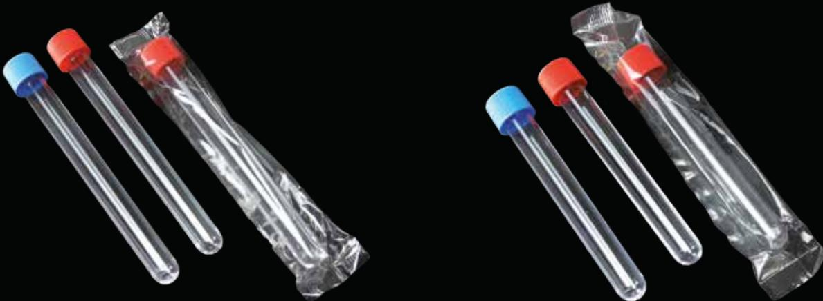
Polystyrol-Röhrchen nicht graduiert mit Schraubverschluss, der eine perfekte Dichtheit garantiert, Ø 16 x 150 mm.
