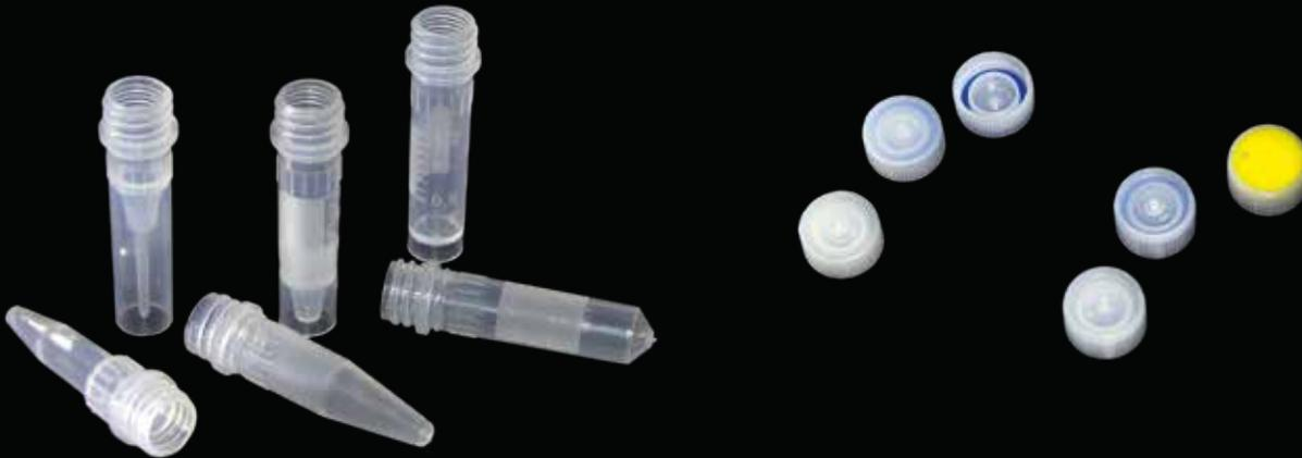
Graduiert, aus transparentem Polypropylen, ohne Deckel. Temperaturbeständigkeit von -90 bis +121 °C, geeignet für den Einsatz in der Zentrifuge bis RCF 25.000 g. DNase-, RNase- und Pyrogenfrei.
