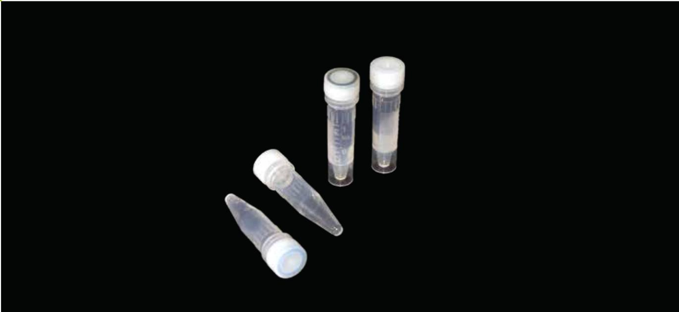
Graduierte Mikroröhrchen aus transparentem Polypropylen, temperaturbeständig von -90 bis +121 °C, geeignet für den Einsatz in der Zentrifuge bis max. RCF 25.000g. DNase-, RNase- und Pyrogenfrei.
