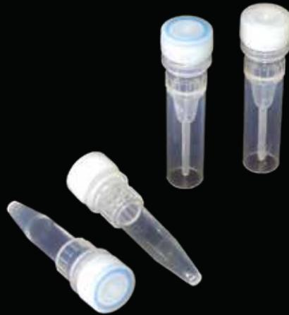
Mikroröhrchen aus transparentem Polypropylen, temperaturbeständig von -90 bis +121 °C, geeignet für den Einsatz in der Zentrifuge bis max. RCF 25.000 g. DNase-, RNase- und Pyrogenfrei.
