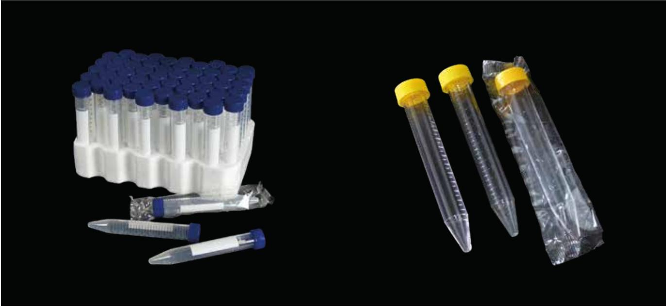
Reagenzgläser aus Polypropylen, bedruckt, mit festem Schraubverschluss. Maße: 17 x 120 mm. RCF max = 10.000 g. Autoklavierbar bei +121 °C und gefrierbar bis -80 °C.
