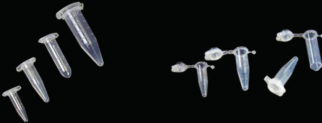
Mikro-Röhrchen mit Sicherheitsverschluss in der Kappe integriert, um ein unbeabsichtigtes Öffnen und Verdampfen der Kappe zu verhindern. Aus Polypropylen, graduiert, mit Schreibfläche und flacher durchstechbarer Kappe. Sie sind zertifiziert frei von menschlicher DNA, PCR-Inhibitoren, ATP, DNase, RNase und Pyrogen. Nicht zytotoxisch, nicht hämolytisch. Geeignet für PCR- und molekularbiologische Anwendungen. Gebrauchstemperatur: -80 bis +100 °C. Autoklavierbar, bei +121 °C für 20 Minuten öffnen.
