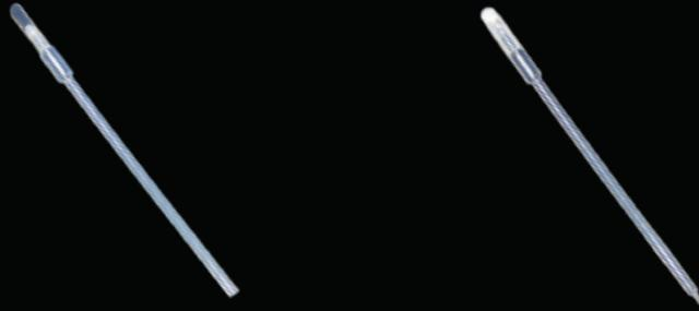
Wird für den Transfer kleiner Mengen verwendet. Der integrierte starre Paddle kann zum Mischen und Schmieren verwendet werden. Länge 125 mm und Außenkapillare Ø 3,6 mm. Gesamtkapazität 0,8 ml, Kolbenauszug 0,2 ml.
