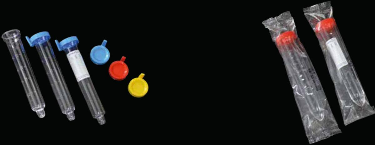
Reagenzglas aus Polystyrol, graduiert, mit Dummy für Sedimentsammlung, auch erhältlich mit Polyethylen-Kappe mit Hygienegriff, gemischt lose verpackt, Vol. 12 ml, Ø 17 x 105 mm.
