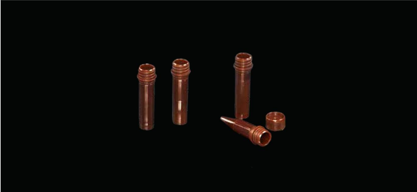
Aus Polypropylen, lichtundurchlässig (opak) für empfindliche Proben. Temperaturbeständigkeit von -196 bis +121 °C. RNase-, DNase-, DNA- und Pyrogenfrei. Maße: 11 x 44 mm.
