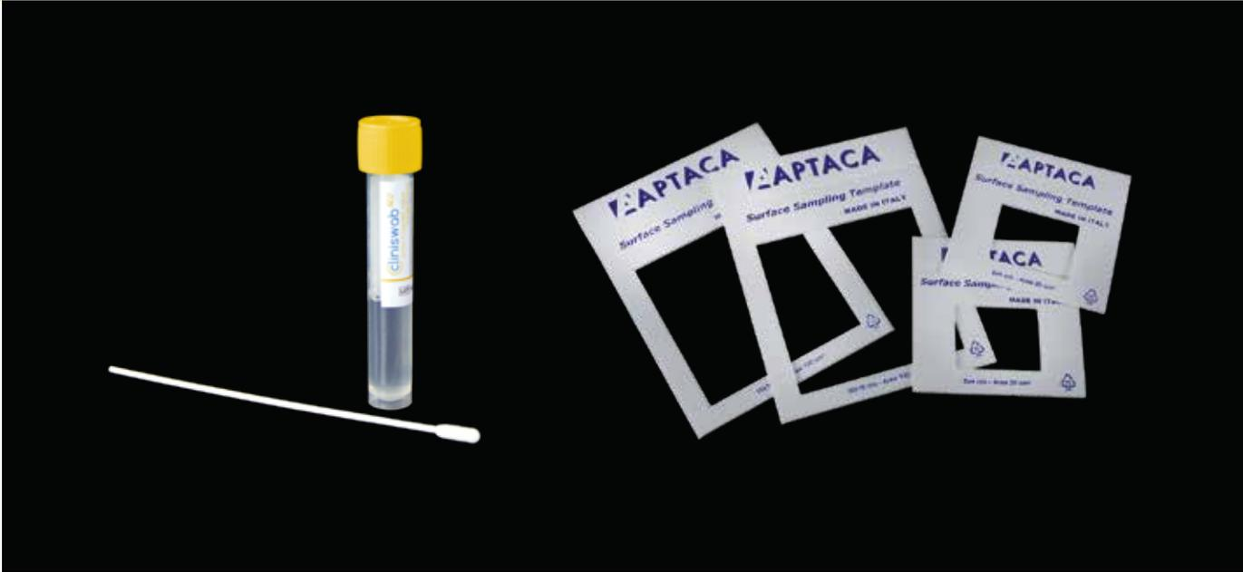
Tupfer mit gelbem Schraubverschlussgefäß, das 5 ml hemmende isotonische Kochsalzlösung enthält. Vormarkiertes Reagenzglas, um eine korrekte Identifizierung der Proben und der Entnahmestelle zu ermöglichen.
